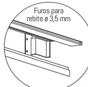
Furos para rebite  $\varnothing$  3,5 mm
