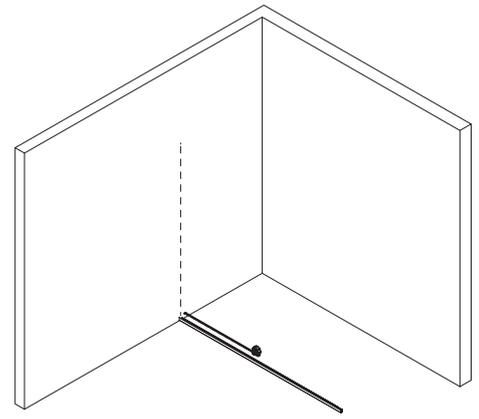
A partir do piso, marque a altura de 1835mm, após a marcação, meça 37mm acima e repita o procedimento em ambos os lados (certifique-se que estejam nivelados). Alinhe a marcação com o centro do perfil guia, e em seguida faça as devidas furações e fixe o parafuso de baixo do terminal. Meça do topo do guia até a cavidade do terminal de fixação, corte e faça a fixação e vedação dos dois perfis U de fixação.
