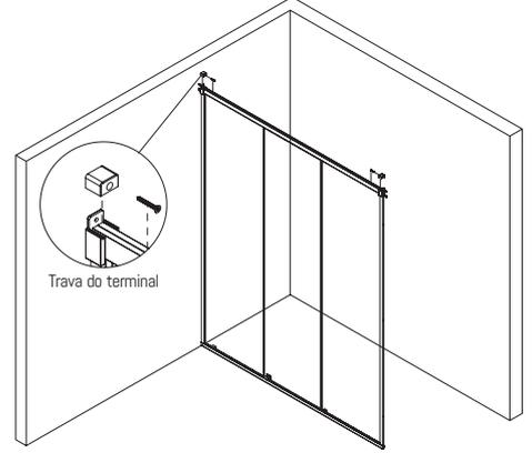
Retire o parafuso e as arruelas de ajuste das roldanas. Feito isso, encaixe-as no trilho superior para que possa ser colocado o vidro da porta.
