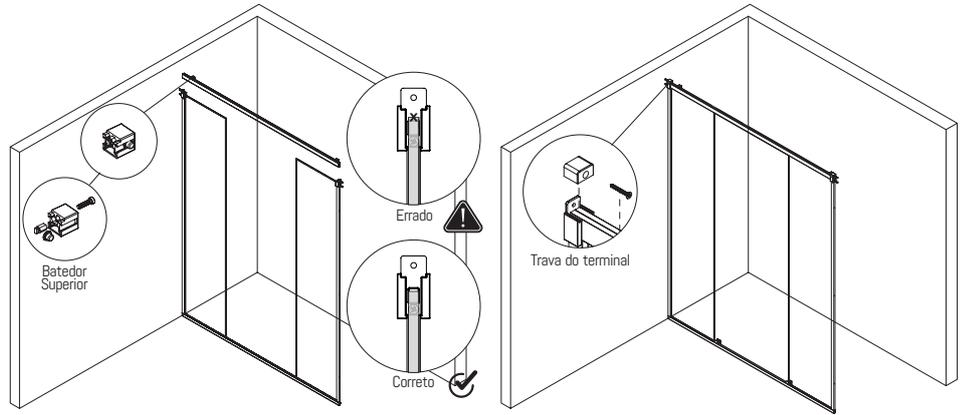
Retire o parafuso e as arruelas de ajuste das roldanas. Feito isso, encaixe-as no trilho superior para que possa ser colocado o vidro da porta (posicione duas roldanas por vez).
