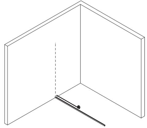
Para o primeiro furo do terminal de fixação, meça a altura da porta e desconte 45mm (Ex. 1880 - 45mm = 1835), feito isso acrescente 35mm (segundo furo), certifique-se que a marcação/furo fique alinhado com o centro do perfil guia e fixe o terminal. Corte os perfis U 73mm menor que a altura da porta (Ex. 1880 - 73mm = 1807) e faça as devidas fixações, encaixando-o no terminal de fixação.
