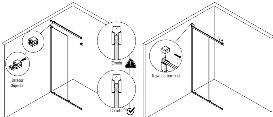
Retire o parafuso e as arruelas de ajuste das roldanas. Feito isso encaixe-as no trilho superior para que possa ser colocado o vidro da porta.
