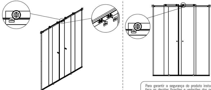
Para garantir a segurança do produto instalado, faça as devidas fixações e vedações dos perfis. Com isso você terá uma instalação com qualidade segura e eficiente.
